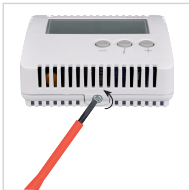
Abb.1 Lösen Sie die Feststellschraube und nehmen Sie das Bedienteil vom unteren Gehäuse des Gerätes ab.
