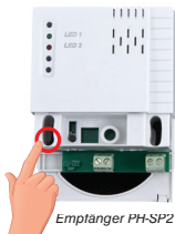
E Drücken Sie auf dem EMPFÄNGER* kurz die Funktionstaste für ca. 1s.
