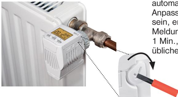
Auf der Anzeige erscheint nach der Montage des Kopfes auf das Ventil die Meldung "Ad:AP", der Kopf passt sich automatisch dem Ventil an (sollte die Anpassung nicht richtig durchgeführt sein, erscheint auf der Anzeige die Meldung **Err**). Die Anpassung dauert ca. 1 Min., dann geht der Kopf in den üblichen Modus zurück.
